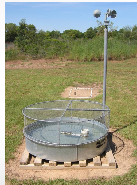
Sl. 39. Isparitelji klase A za merenje isparavanja sa slobodne vodene površine
