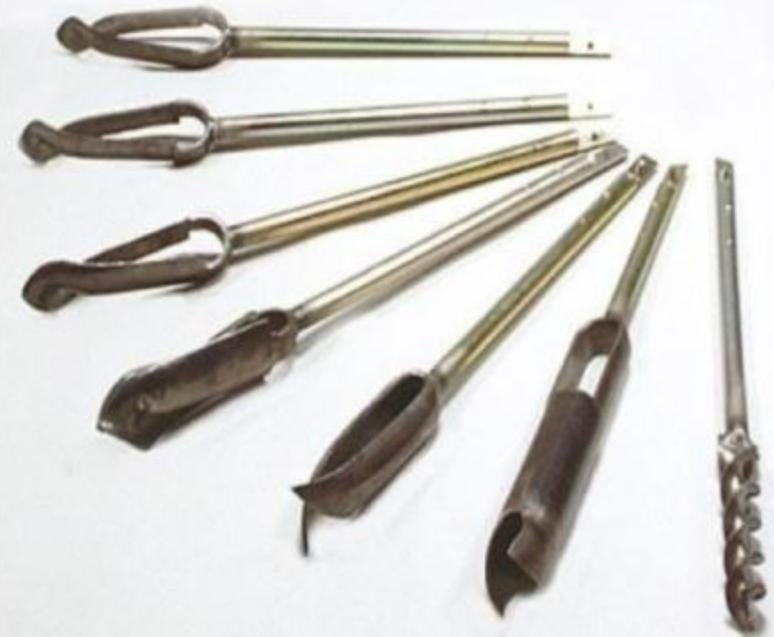
**Način uzimanja uzoraka:** Sonda se u zemljište utiskuje snagom ruku, u pravcu kretanja kazaljke na satu. Kad se stigne do željene dubine sonda se okreće u suprotnom smjeru i izvadi iz zemljišta. Sadržaj zemljišta iz radnog dijela sonde se stavlja u kese ili odgovarajuće aluminijumske kutijice dimenzije 5x4 cm. Uzorci se uzimaju u najmanje tri do pet ponavljanja. Transport uzoraka do laboratorije treba obaviti što je moguće prije, kako ne bi došlo do gubitaka vlage iz njih.
