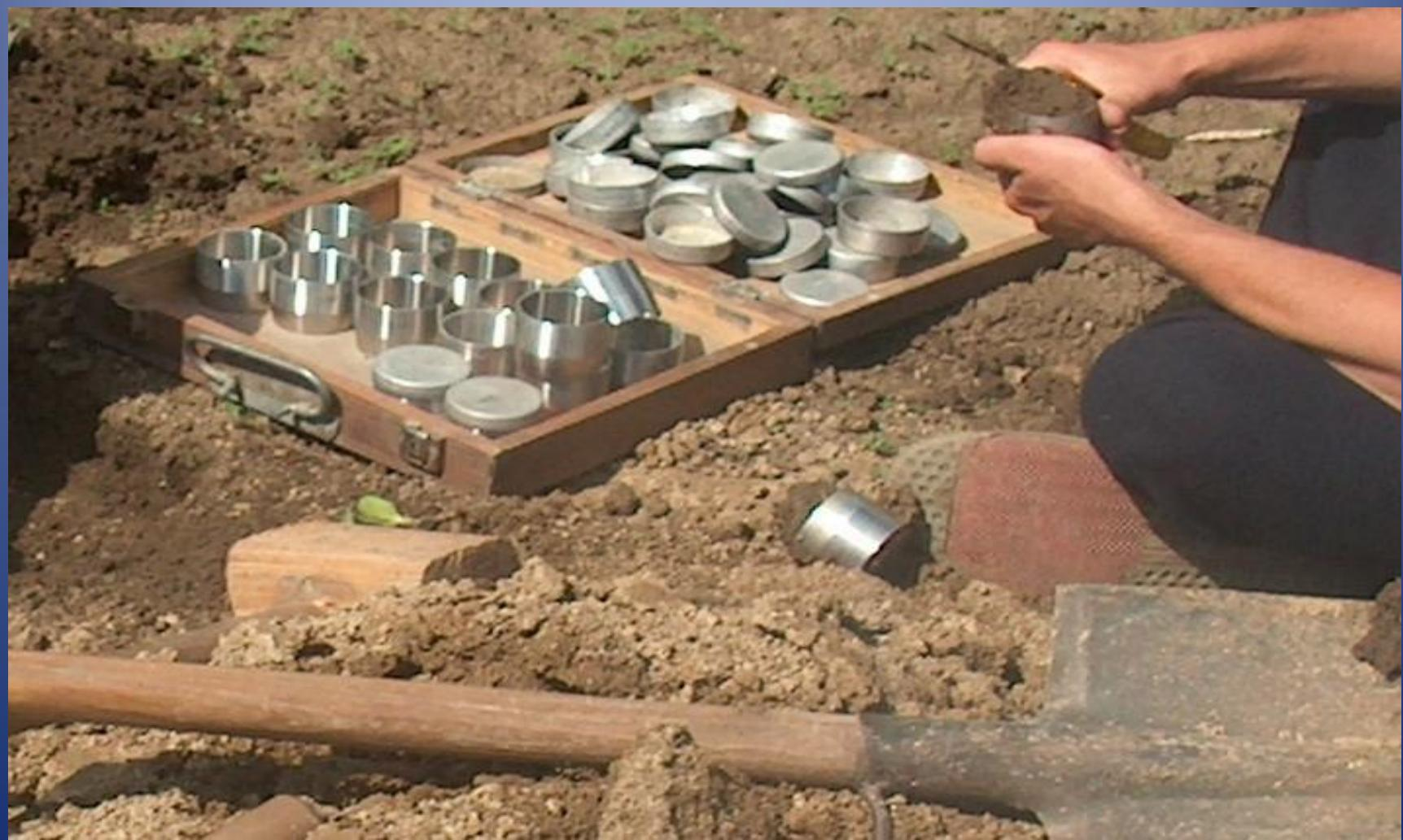
U kompletu pribora, uz cilindre, neophodno je raspolagati i sledećim nastavkom za cilindre, postoljem, drvenim ili čekićem od tvrde gume, oštrim nožem sa tankim profilom, ašovom. Cilindar je na jednom kraju, po obodu sa spoljašnje strane istanjen, naoštren, radi lakšeg utiskivanja u zemljište. Cilindri imaju i poklopce koji mogu biti metalni ili plastični. Cilindri se numerišu odgovarajućim brojem.
